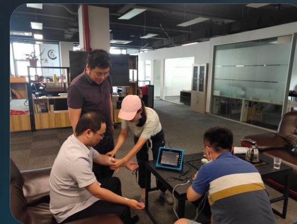
现场人体实测-波形效果 (指尖干电极检测)
