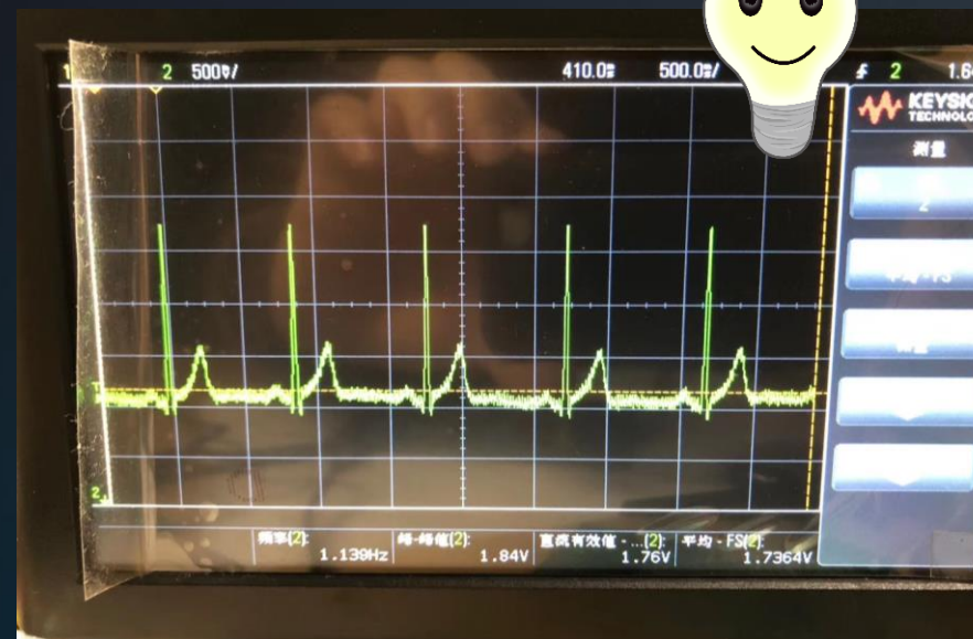
样品测试-波形效果 (心口湿电极检测) 极低频率成分保留完整, 波形轮廓医疗级
