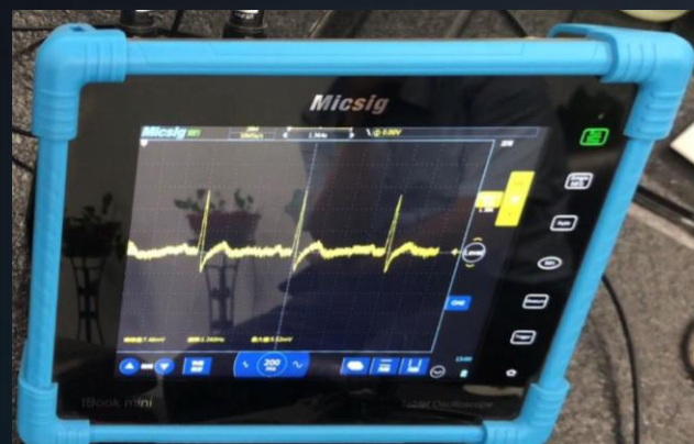
现场人体实测-波形效果 (指尖干电极检测)
